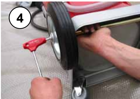
4 Serrare le viti dei tasselli Tighten the bolts of the axle Serrer les boulons de l'essieu Die Schraube der Dübel anziehen
