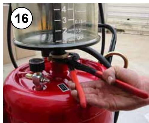
16 Stringere la ghiera del visore Tighten the ring nut of the viewer Serrer l'embout du voyant Die Nutmutter des Messbecher anziehen
