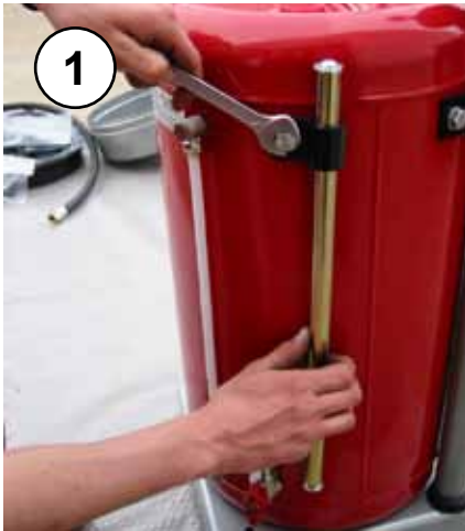
1 Togliere l'assale ruote Remove the wheel axle Enlever l'essieu roues Die Radachse entfernen
