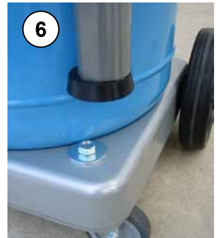
6 Inserire il portasonde sul dado della ruota Insert the probe-holder on the nut of the wheel Insérer le porte-sonde sur l'écrou de la roue Die Sonden hälter auf der Schraubenmutter der Räder einsetzen
